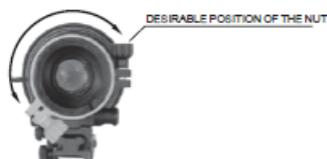
7. Richten Sie den Sitz des PS 22 und des Montagesystems an der Day Scope Linse aus. Bestimmen Sie die gewünschte Position der Feststellmutter und drehen Sie das System bis zur gewünschten Position (s. Pfeil in Abb. 2-4).
